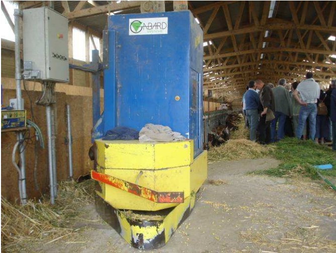
Le robot d'alimentation est programmé pour mélanger les céréales et compléments lors de la distribution
