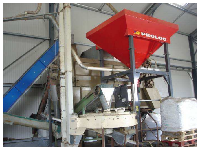
Une unité de granulation fabrique des « bouchons » de paille de céréales ou colza, fientes séchées, composts.
